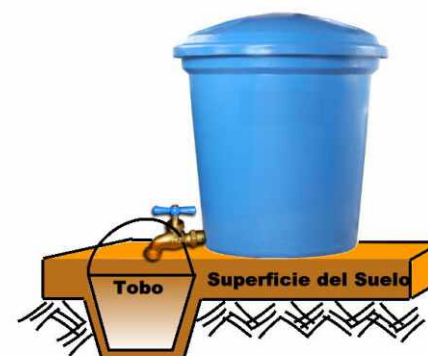
Figura 37 Tanque sobre la superficie del suelo "Modelo A".
